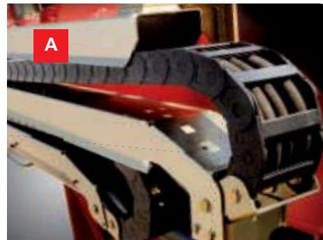
**ES A** Tuberías adicionales° para el uso de accesorios hidráulicos, en grúas y en extensiones hidráulicas, protegidas por un sistema Fassi exclusivo constituido por canaletas metálicas combinadas con cadenas de guía de nylon de alta resistencia.
