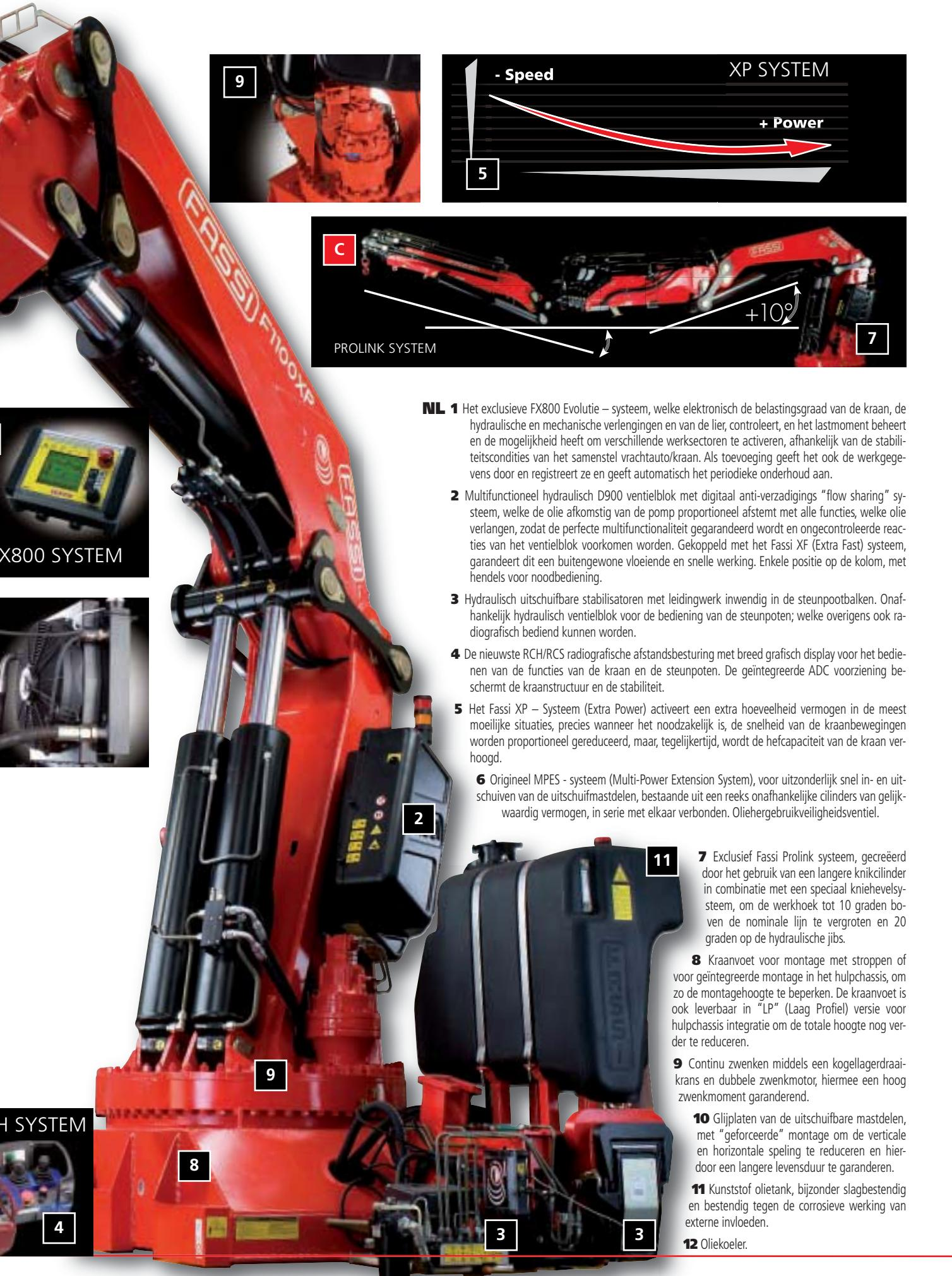
**NL 1** Het exclusieve FX800 Evolutie – systeem, welke elektronisch de belastingsgraad van de kraan, de hydraulische en mechanische verlengingen en van de lier, controleert, en het lastmoment beheert en de mogelijkheid heeft om verschillende werksectoren te activeren, afhankelijk van de stabiliteitscondities van het samenstel vrachtauto/kraan. Als toevoeging geeft het ook de werkgegevens door en registreert ze en geeft automatisch het periodieke onderhoud aan.
